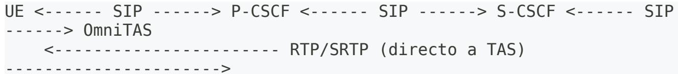
El P-CSCF maneja solo la señalización SIP. Todos los medios (voz, video) se establecen directamente entre el UE y OmniTAS.
